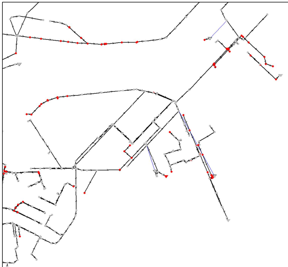
Figur 13 Brunnar med röd färg visar där vattnet överskrider marknivå vid dimensionerade 30 års regn.
